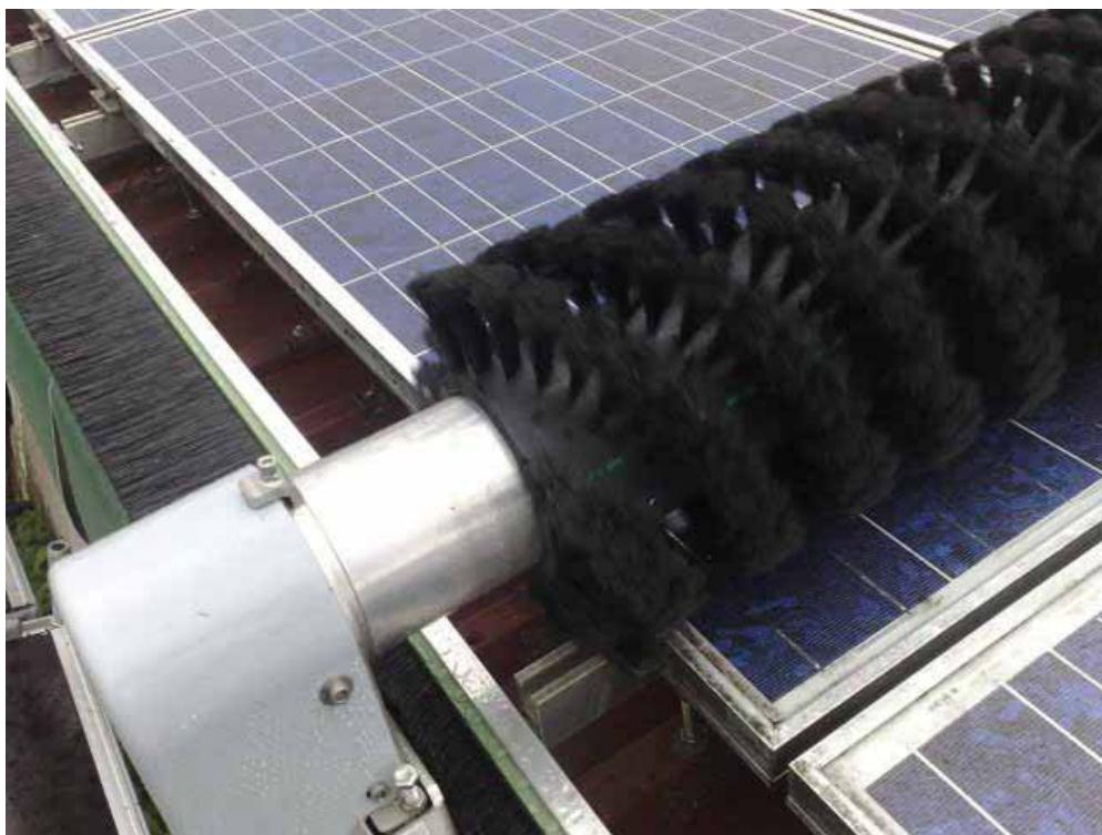
Rys 9) Bezwodna technologia czyszczenia paneli fotowoltaicznych.
