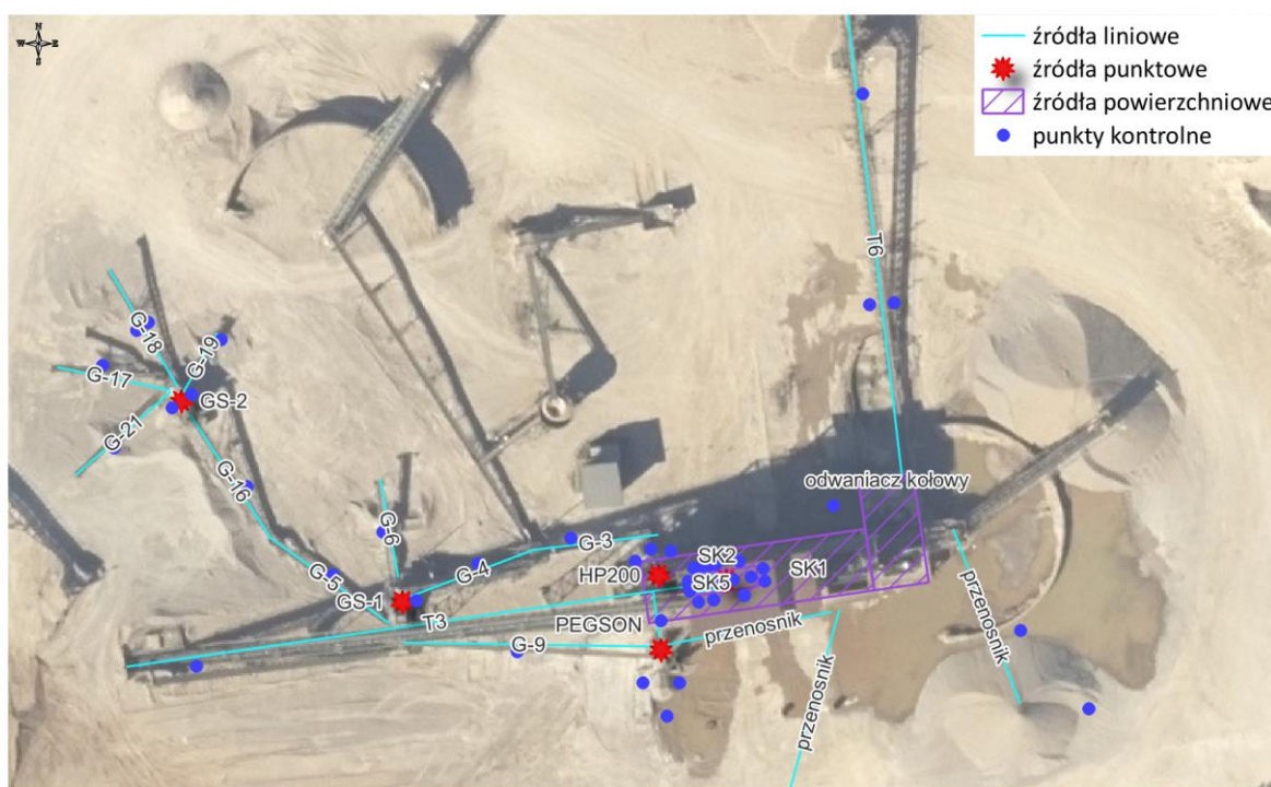
Rysunek 9 Schemat rozmieszczenia zastępczych źródeł hałasu oraz punktów kontrolnych
