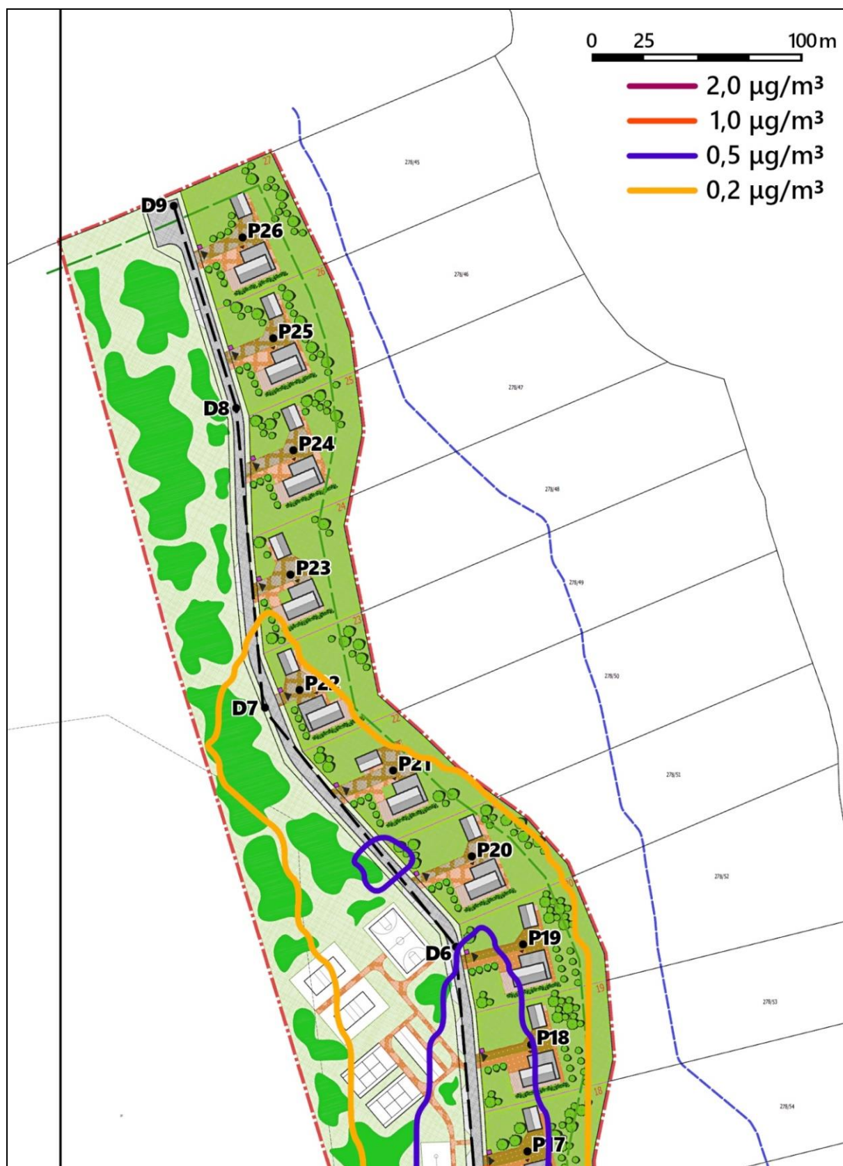
Rys. 22C. Rozkład stężeń maksymalnych dwutlenku azotu \text{NO}_2 (dopuszczalny poziom D_1 = 200 \mu\text{g}/\text{m}^3 )
