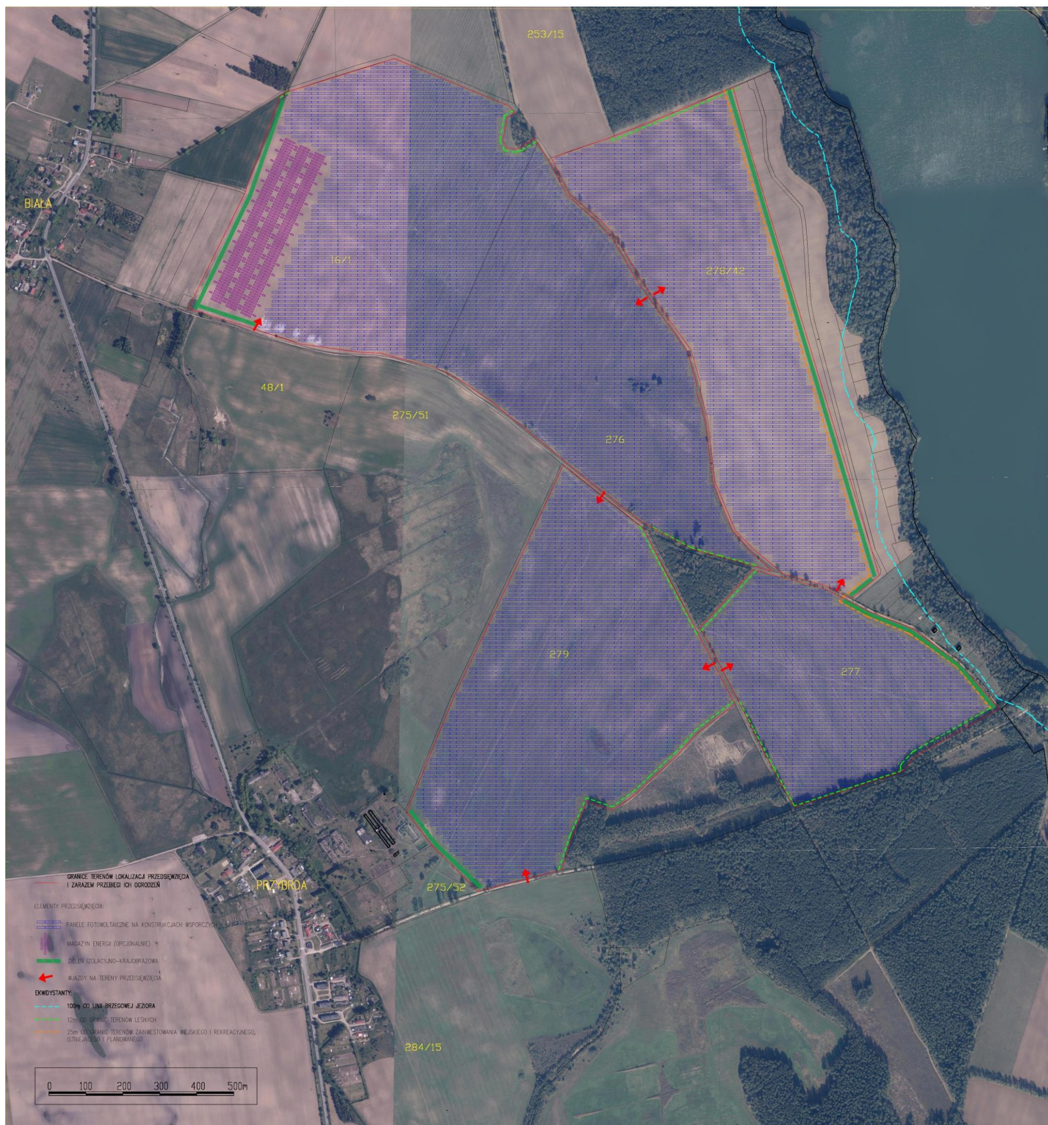
Rys. 5. Plan zagospodarowania terenu Farmy Fotowoltaicznej „Przybrda” w wariantcie proponowanym przez wnioskodawcę (źródło: materiały wnioskodawcy)
